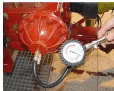
BOMBA Mesura de la pressió interna de l'amortidor
