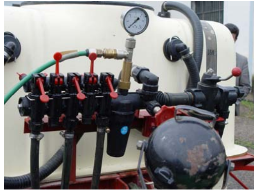
REGULADOR I DISTRIBUIDOR
