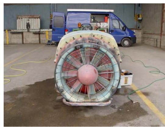
PROTECCIÓ I SEGURETAT Reixes del ventilador
